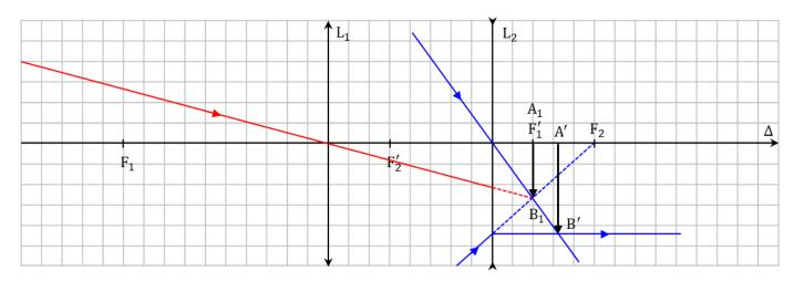
13) L'utilisation d'une lentille divergente permet, pour une image de taille donnée, de réduire l'encombrement (distance entre la première lentille et le capteur). En effet, on peut voir sur le schéma précédent que pour obtenir une image de la taille de A'B' avec le rayon rouge uniquement, le capteur aurait dû être placé bien plus loin.
